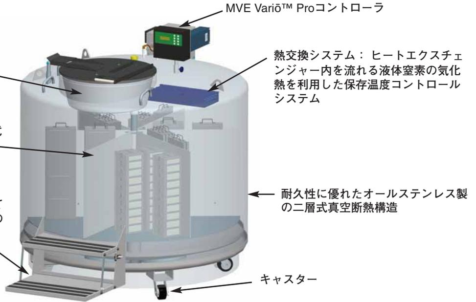
MVE Variō™シリーズの画期的な熱交換システム(特許申請中)は、容器内部にあるヒートエクスチェンジャーに液体窒素を流し、その気化熱を利用して容器内を冷却します。この熱交換システムは、液体窒素の熱容量を最大限に利用しながら同時に容器内の霜や水分を排除します。MVE Variō Proコントローラは、ヒートエクスチェンジャーに送られる液体窒素の量を監視・測定します。このことにより、容器内は完全な気相状態で $-50^{\circ}\text{C}$ から $-150^{\circ}\text{C}$ の範囲で任意の温度に設定することができます。
